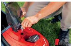
Для защиты от случайного запуска вся техника оснащена ключом безопасности. Мотор заведется только после того, как ключ будет вставлен и повернут, а вынув ключ, газонокосилку можно со спокойной совестью оставить без присмотра.
